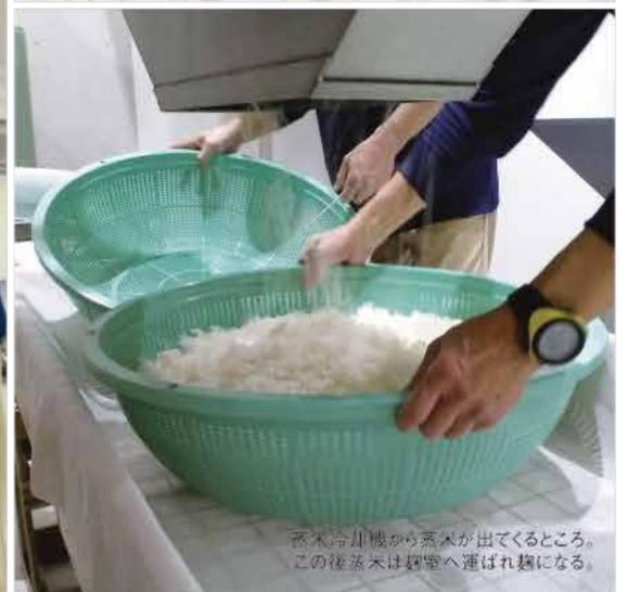
蒸米冷却機から蒸米が出てくるころ。この後蒸米は麹室へ運ばれ麹になる。
